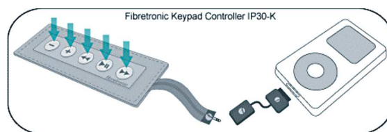
Schemat współpracy listwy sterującej Fibretronic z iPod-em [11]
