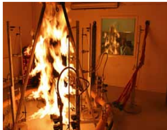
Rysunek 5: Badania na urządzeniu Thermoman w SATRA Technology Center (UK) [5]
