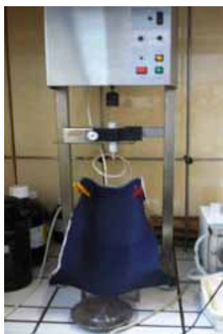
Rysunek 8: Stanowisko do badania odporności na ciepłe substancje chemiczne wg normy EN ISO 6530, w Centralnym Instytucie Ochrony Pracy – Państwowym Instytucie Badawczym w Łodzi
