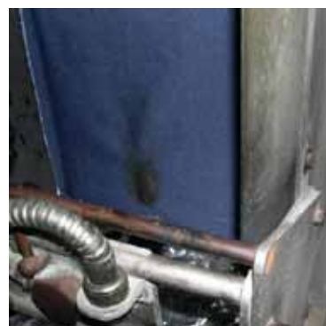
Rysunek 6: Stanowisko do badania rozprzestrzeniania się płomienia wg normy EN ISO 15025:2002, w ITB "MORATEX"
