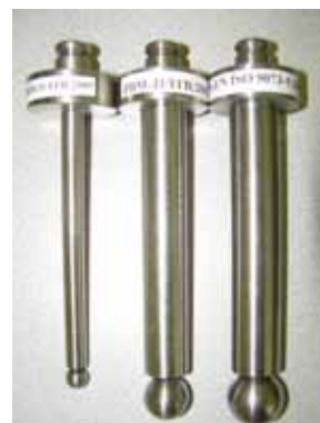
Rysunek nr 3 - Elementy robocze (trzczenie zakończone kulką), kolejno od lewej: Ø10 mm, Ø20 mm, Ø25.4 mm
