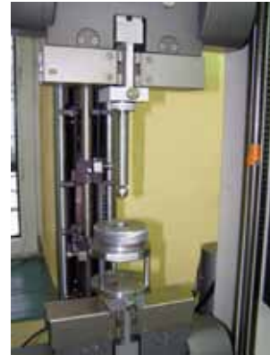
Rysunek nr 1 - Stanowisko badawcze wg PN-79/P-04738 (PBM-31/ITB:2009)
