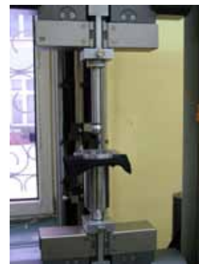
Rysunek nr 2 - Stanowisko badawcze wg PN-EN ISO 9073-5:2008
