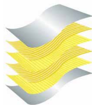
Rysunek 10. Budowa balistycznego materiału kompozytowego Gold Flex ® [31]
