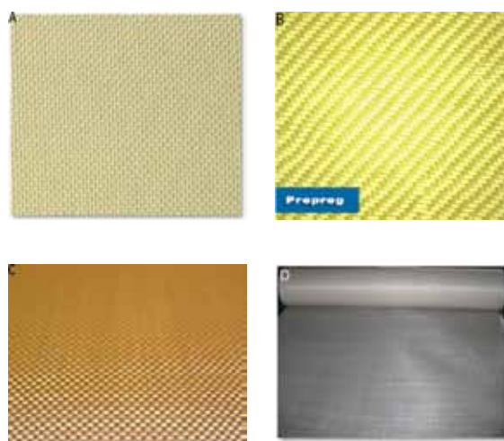
Rysunek 9. Zdjęcia przykładowych surowców balistycznych (a) tkanina z włókien para-aramidowych Kevlar ® lub Twaron ® , (b) preimpregnat na bazie tkaniny z włókien para-aramidowych i żywicy polimerowej, (c) tkanina z włókien Zylon ® , (d) nietkany wyrób na bazie włókien polietylenowych.
